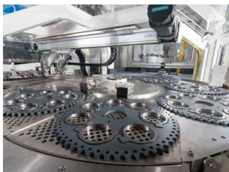
Blick in den Twin Loader – für kürzesten Läuflerscheibenaustausch
